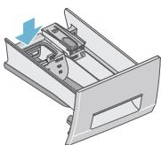
5. Inserire completamente il cassetto del detersivo.
