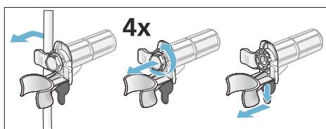
3. Montare le coperture. Bloccare saldamente in posizione le coperture facendo pressione sugli agganci a scatto.
