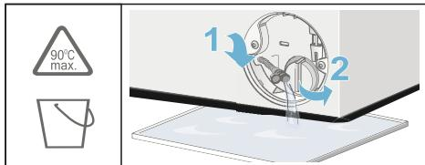
5. Svitare con cautela la copertura della pompa; è possibile la fuoriuscita di acqua residua.
