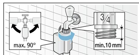
**Avvertenza:** Aprire con cautela il rubinetto dell'acqua, controllando la tenuta dei punti di collegamento. Il raccordo a vite è sotto la pressione delle tubature principali dell'acqua.
