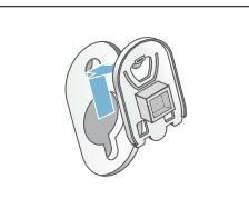
2. Inserire tutte e quattro le boccole. Fissare saldamente il cavo di alimentazione nei supporti. Inserire e stringere le viti.
