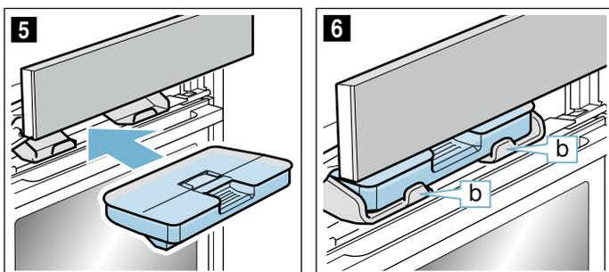
9. Poussez lentement le bandeau vers le bas, puis vers l'arrière jusqu'à ce qu'il soit entièrement fermé. Le réservoir d'eau est rempli. Vous pouvez démarrer des modes avec de la vapeur.
