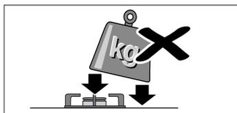
S nádobami na varnom paneli manipulujte opatrne. Vyhnite sa preťažovaniu varného panela, nevystavujte jeho povrch nárazom.
