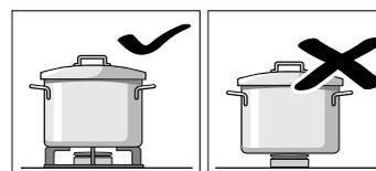
Posode postavite na rešetke, nikoli neposredno na gorilnik. Pred uporabo se prepričajte, da so rešetke za posode in pokrovi plinskega gorilnika pravilno nameščeni.
