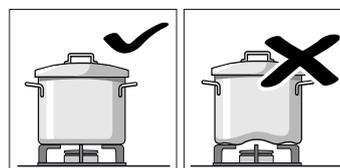
Nepoužívejte zdeformované nádoby, které jsou na varné desce vratké. Mohly by se převrhnout.
