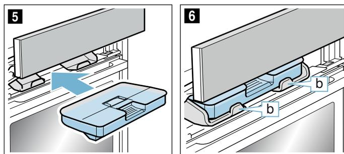
9. Empurre a aba lentamente para baixo e, em seguida, pressione para trás, até fechar completamente.
