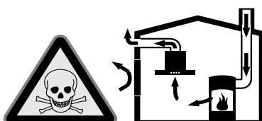
A belső levegőről függő tűzhelyek (pl. gáz-, olaj-, fa- vagy széntüzelésű fűtőberendezések, átfolyós vízmelegítők, melegvízkészítő rendszerek) elszívják az égéslevegőt a felállítási térből, és egy füstgáz-berendezésen (pl. kúrtón) keresztül a szabadba vezetik az elhasznált gázt.
