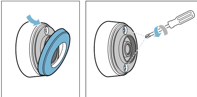
2. Rimuovere la parte superiore dell'alloggiamento. Rimuovere la batteria esausta. Inserire la batteria nuova. Prestare attenzione alla disposizione dei poli.
