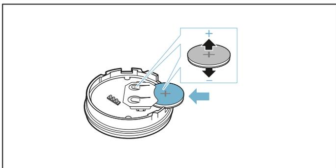
3. Rimontare la parte superiore dell'alloggiamento con la parte inferiore dello stesso. Prestare attenzione al corretto orientamento dei contatti.
