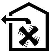
L'air aspiré est débarrassé des particules de graisse par les filtres à cet effet, transite par un conduit puis gagne l'extérieur.
