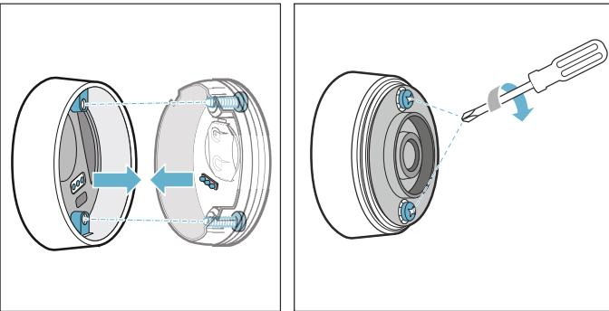
4. Sett silikondekselet tilbake på undersiden av temperatursensoren.
