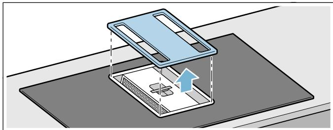
**Merk:** Pass på at filterdekselet ikke faller ned og skader koketoppen.
