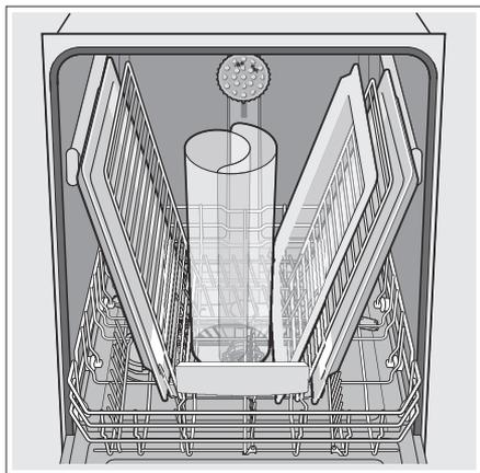
**Remarque :** L'orifice de ventilation [25] sur le côté gauche de la cuve à détergent doit être libre et pour cela, les articles de grande taille comme les planches à découper en plastique et les grandes plaques à pâtisserie doivent être placés au centre ou sur le côté droit du panier inférieur.
