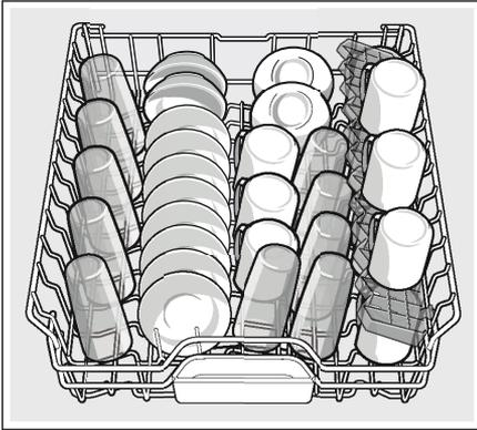
**Remarque :** Le repliage des étagères à tasses permet aux tasses d'être disposées selon un angle accru et de réduire les accumulations d'eau au fond de celles-ci.
