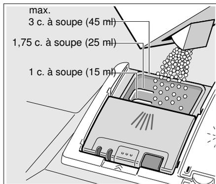
En cas d'utilisation de comprimés détergents, placez-les de telle sorte qu'ils n'entrent pas en contact avec le couvercle. Insérez-les à plat et non sur le côté.
