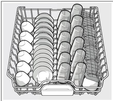
**Remarque :** Le repliage des étagères à tasses permet aux tasses d'être disposée selon un angle accru et de réduire les accumulations d'eau au fond de celles-ci.
