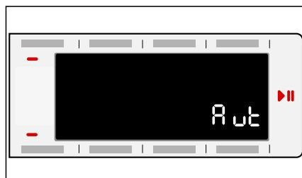
3. Ağ bağlantısı oluşturmak için Başlat/Beklet ▷ tuşuna basınız. Ekranda **WiFi** yanıp söner. Cihaz bunun ardından ev ağına bağlanmayı dener.
