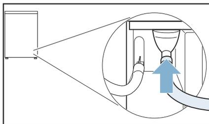
6. Selon la situation de raccordement, fixez l'autre extrémité du tuyau d'évacuation avec les accessoires restants.
