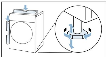
3. Si nécessaire, réalignez l'appareil en tournant les pieds de l'appareil. Vous pouvez à présent raccorder l'appareil.
