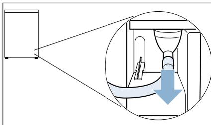
**Remarque :** À la livraison de l'appareil, le tuyau d'eau de condensation est fixé à un support.
