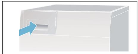
**Hinweis:** Das Sieb im Kondenswasser-Behälter filtert das Kondenswasser, das zur automatischen Reinigung Ihres Trockners verwendet wird. Das Sieb wird durch Entleeren des Kondenswassers gereinigt. Prüfen Sie das Sieb trotzdem regelmäßig auf verbliebene Ablagerungen und entfernen diese. Siehe → Seite 33.
