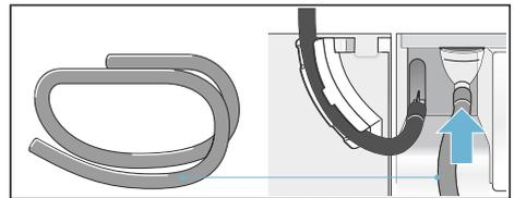
5. Befestigen Sie den Ablaufschlauch mit der anderen Seite je nach Anschluss-Situation A, B oder C mit dem restlichen Zubehör.
