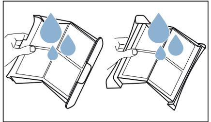
8. Flusensiebe abtrocknen, zuklappen und wieder einsetzen.
