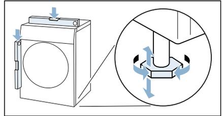
3. Falls notwendig, Gerät neu ausrichten durch Drehen der Gerätefüße.
