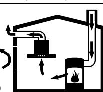
Vatrišta koja zavise od vazduha u prostoriji (npr. grejni uredaji na gas, ulje, drvo ili ugalj, protočni bojleri, kotlovi za zagrevanje vode) vazduh za sagorevanje crpe iz prostorije u koju su postavljeni i izdunve gasove izbacuju preko sistema za izdunve gasove (npr. kamoin) u spoljašnju sredinu.
