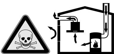
Kurišča, odvisna od zraka v prostoru (npr. grelne naprave na plin, olje, les ali premog, preočni grelniki, bojlerji) črpajo zrak za izgorevanje iz prostora, v katerem so nameščeni, in odvajajo izpušne pline prek sistema za odvajanje plinov (npr. dimnika) na prosto.
