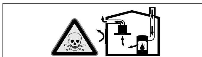
Зависимите от стайнния въздух печки (напр. нагревателните уреди, работещи с газ, нафта, дърва или въглища, конвекторните нагреватели, калориферите) изтеглят въздух за изгаряне от мястото на поставяне и изкарват отработени газове през съоръжение за отработени газове (напр. димоотвод) на открито.
