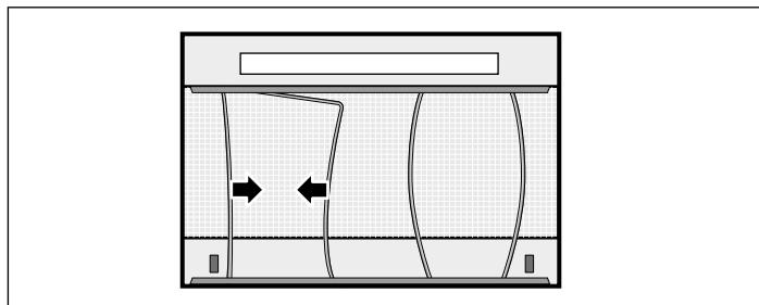
5. Nakon demontaže filtera za masnoću od flisa očistite uredaj iznutra.
