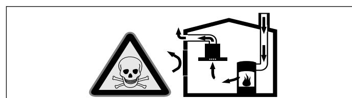
Grijala na plamen koja ovise o zraku iz prostorije (npr. plinska grijala, grijala na ulje i drva ili ugljen, protočni grijaci vode, uređaji za pripremu tople vode) troše zrak za sagorijevanje iz prostorije u kojoj je postavljen uređaj i odvode dimne plinove kroz dimovodne uređaje (npr. dimnjak) na otvoreno.
