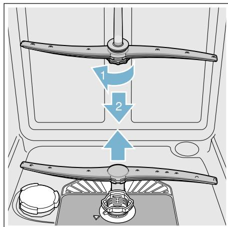
4. Sprüharme unter fließendem Wasser reinigen.
