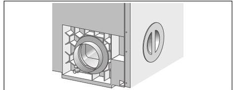
L'ouverture d'évacuation d'air sur le panneau arrière est ouverte lorsque le sèche-linge est livré (anneau de baïonnette). L'ouverture d'évacuation d'air sur le panneau de gauche est scellée avec un couvercle.
