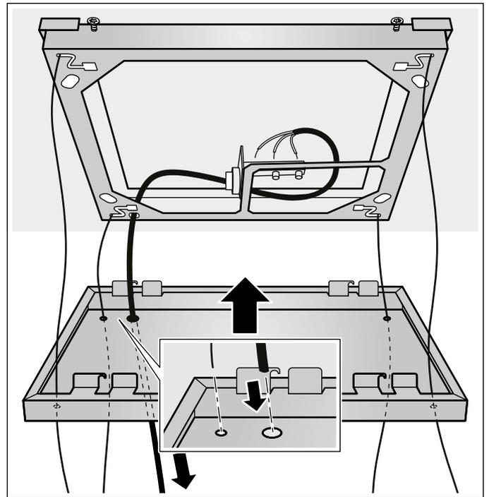
2. Rahmenabdeckung an den 4 Schrauben am Rahmenrand einhängen.
