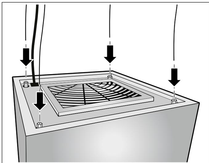
3. Gerät entsprechend der Sicherheitsabstände nach oben schieben und waagrecht ausrichten.
