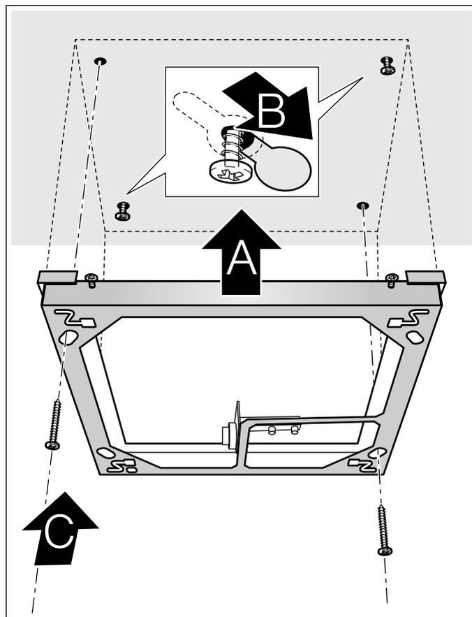
3. Rahmen mit zwei weiteren Schrauben festschrauben. **C** Alle Schrauben fest anziehen.
