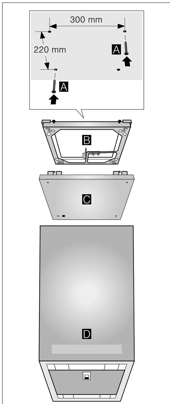
2. Die beiden Schrauben an der Decke durch die dafür vorgesehenen Öffnungen im Rahmen führen **A**. Rahmen verschieben, so dass die Schrauben in den Schlüssellochöffnungen eingeschraubt werden können **B**.
