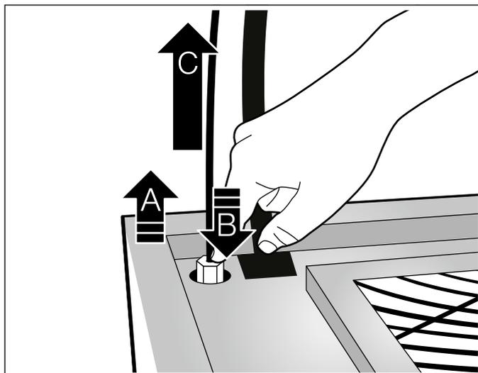
5. Nach dem Ausrichten die Seilspanner mit einem Gabelschlüssel (Schlüsselweite 7) festziehen.
