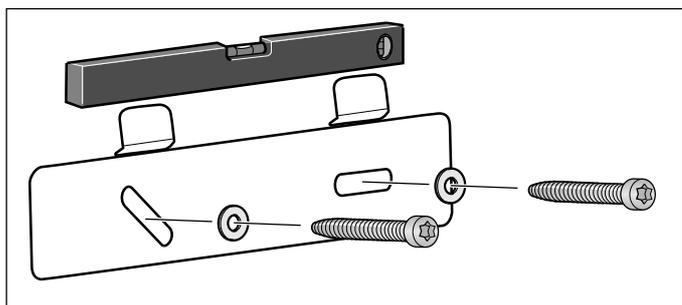
2. Gewindebolzen so weit einschrauben, dass er noch **5 - 9 mm** aus der Wand ragt.
