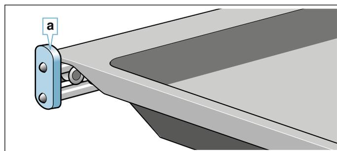
Die Auszugsschienen rasten ein, wenn sie ganz herausgezogen sind. So lässt sich das Zubehör leicht auflegen. Zum Entriegeln die Auszugsschienen mit etwas Druck zurück in den Garraum schieben.
