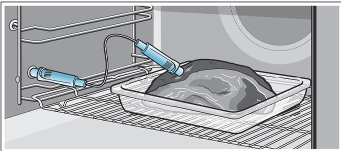
**Fisch:** Ganzen Fisch mit Hilfe einer halben Kartoffel in Schwimmposition auf den Rost stellen. Stecken Sie das Bratenthermometer hinter dem Kopf in Richtung der Mittelgräten bis zum Anschlag ein.
