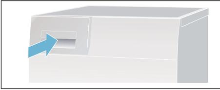
**Nota:** El filtro ubicado en el recipiente de agua de condensación filtra el agua de condensación que se utiliza para la limpieza automática de la secadora. El filtro se limpia al vaciar el agua de condensación. No obstante, es necesario comprobar periódicamente el filtro y eliminar los posibles residuos que se hayan podido acumular. Ver → *Página 38*.
