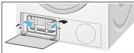
4. Retirar la cubierta superior del intercambiador térmico.
