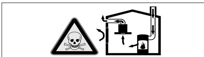
Les foyers à combustion alimentés en air ambiant (par exemple appareils de chauffage, au gaz, au bois, au fioul ou au charbon, les chauffe-eau, chauffe-eau accumulateurs) prélèvent l'air de combustion dans la pièce où ils sont installés et rejettent les gaz de fumée à l'extérieur par le biais d'un système spécifique (cheminée par exemple).
