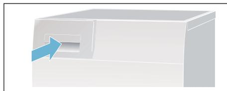
**Remarque :** Le filtre du réservoir d'eau de condensation filtre l'eau de condensation utilisée pour le nettoyage automatique de votre sèche-linge. Le filtre est nettoyé en vidant l'eau de condensation. Vérifiez régulièrement que le filtre ne contient pas de dépôt et retirez-les le cas échéant. Voir → Page 42.
