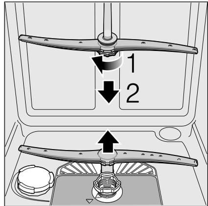
4. Sprüharme unter fließendem Wasser reinigen.
