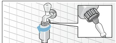
2. Schlauch wieder anschließen und auf Dichtheit prüfen.
