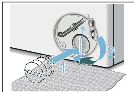
8. Service-Klappe einsetzen und einrasten.
