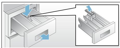
3. Einspülsschale und Einsatz mit Wasser und Bürste reinigen und abtrocknen. Auch Gehäuse innen reinigen.
