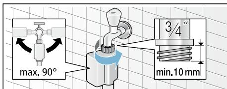
Wasserhahn vorsichtig öffnen und dabei Dichtigkeit der Anschluss-Stelle prüfen. Schraubverbindung steht unter Wasserleitungsdruck.
