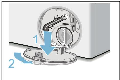
5. Entleerungsschlauch aus der Halterung nehmen. Verschlussklappe abziehen, Lauge in geeignetes Gefäß abfließen lassen. Verschlussklappe aufdrücken und Entleerungsschlauch in die Halterung einsetzen.
