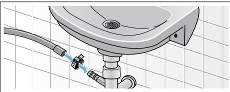
**■ Écoulement dans un tuyau en plastique avec manchon en caoutchouc ou dans un avaloir d'égout**
