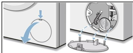
4. Sortir le flexible de vidange de sa fixation. Retirer la coiffe d'obturation, laisser le bain lessiviel s'écouler dans un récipient adéquat.
