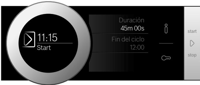
El aparato se encuentra en el modo de espera. Cuando el aparato inicia el funcionamiento, en la pantalla se muestra el transcurso de la duración.
