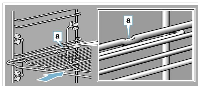
Al introducir las bandejas, asegurarse de que la muesca de enganche **a** se encuentre en la parte trasera y señale hacia abajo. El desnivel de los accesorios **b** debe señalar por delante hacia la puerta del aparato.
