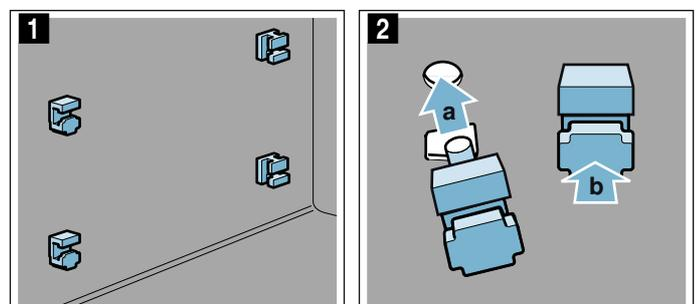
3. Colgar el soporte trasero con el gancho en el orificio superior **a** e introducirlo presionando en el orificio inferior **b** (imagen **3**).
