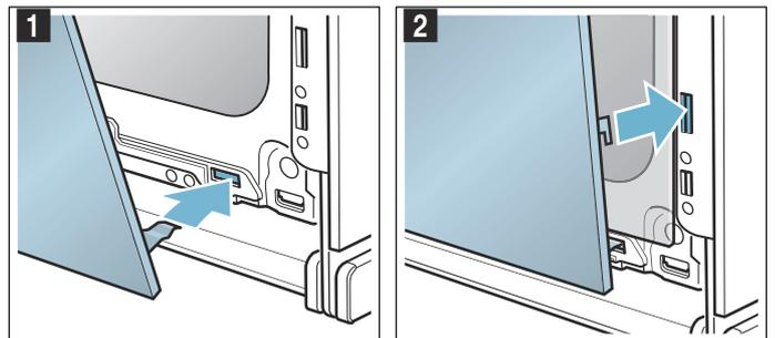
3. Presionar el cristal delantero por abajo hasta que se oiga que ha encajado (figura 3).
