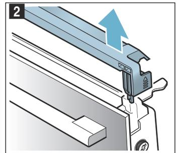
**Nota:** Limpiar la lámina de acero inoxidable insertada en la cubierta con un producto limpiador para acero inoxidable. Limpiar el resto de la cubierta de la puerta con agua con jabón y un paño suave.
