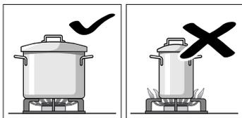
Utilizați recipiente de dimensiune potrivită cu fiecare arzător. Nu utilizați recipiente mici pe arzătoare mari. Flacăra nu trebuie să atingă lateralele recipientului.
