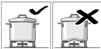
Nu utilizați recipiente deformatate care se dovedesc instabile pe plita de gătit. Recipientele s-ar putea răsturna.
