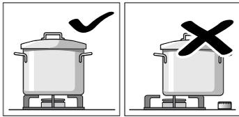
Az edényeket mindig az égő közepére helyezze. Ellenkező esetben az edény felborulhat. Ne tegyen nagy edényeket azokra az égőkre, amelyek közel vannak a kapcsolókhoz. Ez károkat okozhat a túl magas hőmérséklet miatt.
