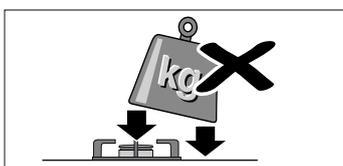
Așezați recipientele pe grătare, niciodată direct pe arzător. Asigurați-vă că grătarele și capacele arzătoarelor sunt bine poziționate înainte de a le folosi.
