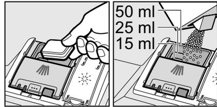
2. Deckel der Reinigerkammer durch Hochschieben schließen, bis der Verschluss problemlos einrastet.
