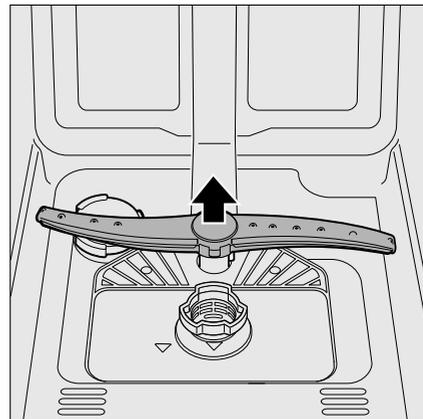
4. Sprüharme unter fließendem Wasser reinigen.
