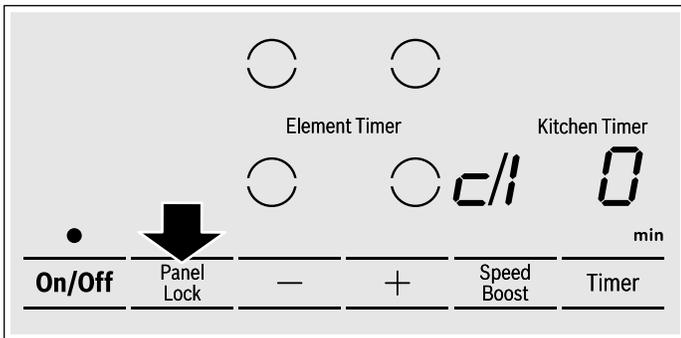
4. Touchez **Panel Lock** (Verrouillage du panneau) à répétition jusqu'à ce que l'indicateur de la fonction souhaitée apparaisse sur l'écran de l'élément.
