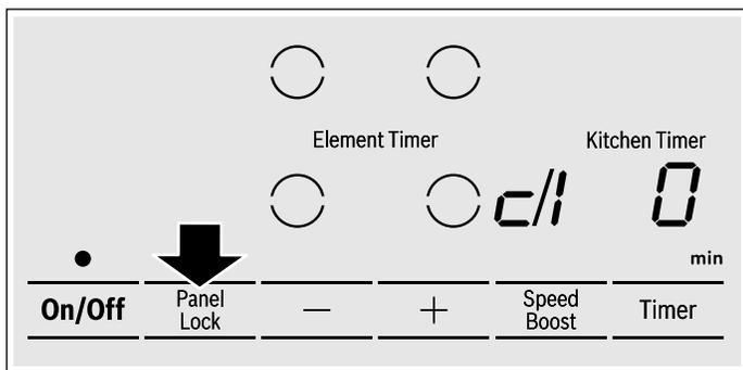
4. Pulsar **Panel Lock** repetidamente hasta que aparezca la indicación visual de la función deseada en el display del elemento.
