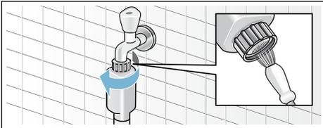
2. Bei Modellen Standard und Aqua-Secure Sieb an der Geräterückseite reinigen:
