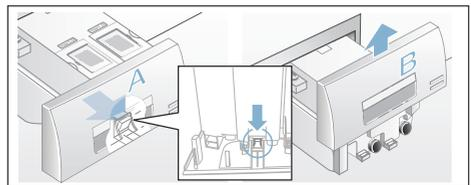
c) Zum Entleeren der Dosierbehälter jeweiligen Verschlussstopfen vorsichtig abziehen und Inhalt in ein geeignetes Gefäß ablassen.
