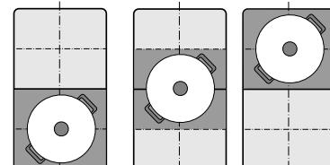
Таким образом, посуда в ходе приготовления может быть перемещена на другую варочную поверхность с другой ступенью нагрева:
