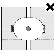
Устанавливайте посуду на варочных панелях с более чем одной свободной зоной нагрева таким образом, чтобы была покрыта только одна из свободных зон нагрева.
