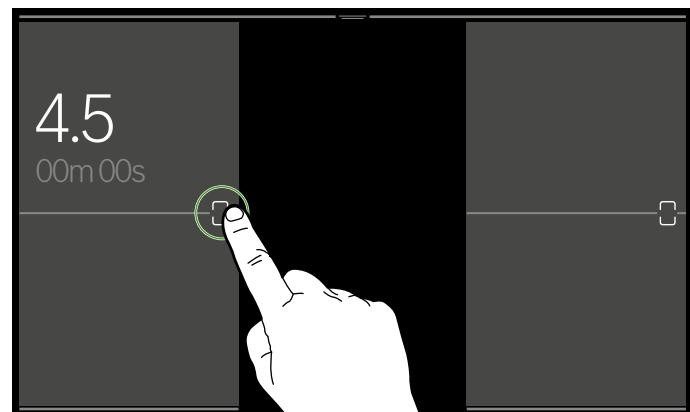
Entrambe le singole aree di cottura sono ora collegate. È possibile modificare del tutto il livello di potenza o la modalità di cottura per l'area di cottura unita.
