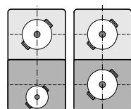
Le aree di cottura anteriore e posteriore, ciascuna con due induttori, possono essere utilizzate indipendentemente l'una dall'altra. Per ciascuna area di cottura singola impostare il livello di potenza desiderato. Utilizzare solo un'unica stoviglia per ciascuna area di cottura.
