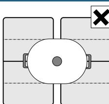
Per piani di cottura con più di un'area di cottura flessibile, accertarsi che la stoviglia sia posizionata in modo tale da coprire soltanto una delle aree di cottura flessibili.
