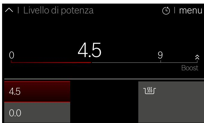
Nel campo di regolazione è possibile impostare diverse modalità di cottura e diversi livelli di potenza per l'area di cottura corrispondente. È possibile modificare i livelli di potenza toccando o strisciando direttamente su una scala. Modificare la modalità di cottura toccando la il tasto "menu" e selezionando un'altra modalità di cottura.
