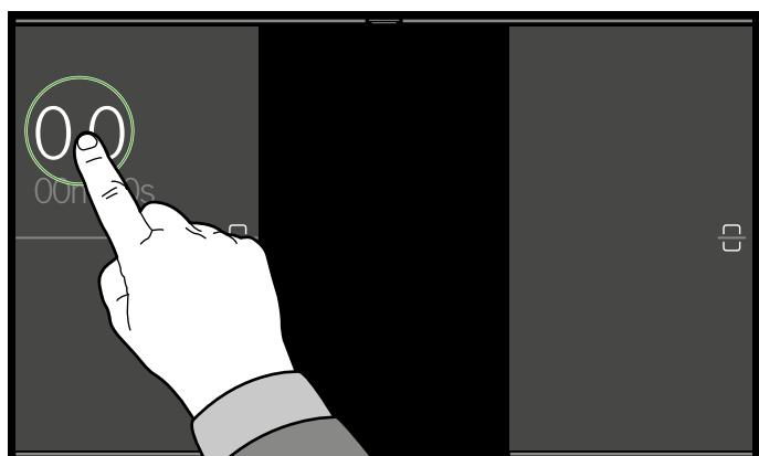
2. De gewenste vermogensstand kiezen door hem direct aan te raken of door over de schaal te wrijven.
