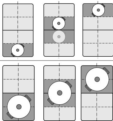
Con questa funzione è possibile adattare il livello di potenza durante il processo di cottura semplicemente collocando la stoviglia in un'altra area.
