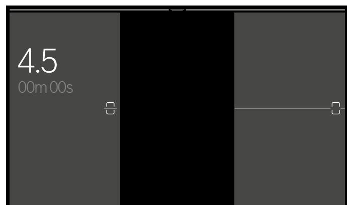
**Avvertenza:** Se si spegne il piano di cottura e lo si riaccende più tardi, l'area di cottura flessibile viene trasformata in due aree di cottura separate.
