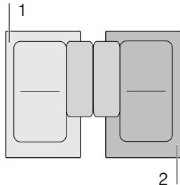
**Avvertenza:** Con un'area di cottura flessibile è possibile attivare anche la funzione quando l'intera superficie viene utilizzata come area di cottura singola.
