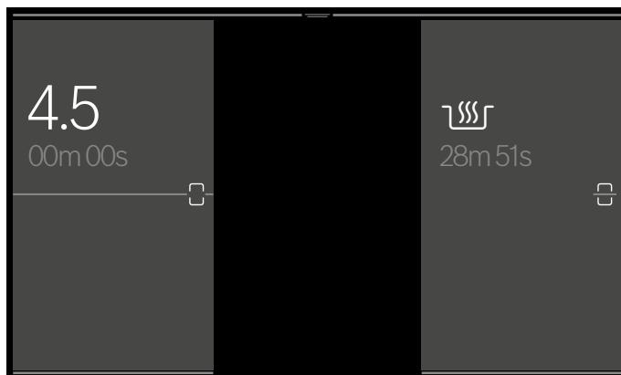
Nel campo principale si vede la forma in cui vengono disposte le singole aree di cottura sul piano di cottura. Vengono visualizzati i tipi di riscaldamento selezionati, i livelli di potenza e le funzioni di tempo dei livelli di cottura attivi. Toccando un'area di cottura, passare nel campo di regolazione della corrispondente area di cottura.
