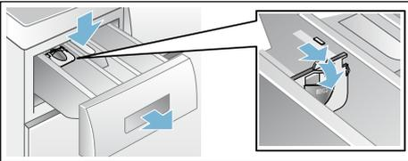
**Avvertenza:** Non utilizzare il dosatore per detersivo tipo gel, detersivo in polvere e per programmi con prelavaggio oppure con funzione Fertig in (Fine fra) selezionata.
