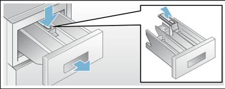
3. Lavare la vaschetta detersivo e l'inserto con acqua e una spazzola e asciugarli. Pulire anche l'interno dell'alloggiamento.
