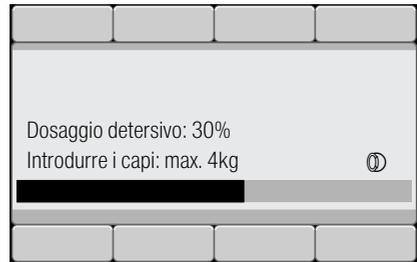
La barra di caricamento si riempie man mano che viene aggiunta la biancheria. Se si supera il carico massimo la barra diventa intermittente. Rispettare la quantità di carico massima indicata. Un carico eccessivo peggiora il risultato di lavaggio e favorisce la formazione di sgualciture.
