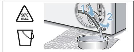
5. Svitare con cautela il coperchio della pompa, l'acqua residua può fuoriuscire. Pulire l'interno, la filettatura del coperchio di pompa e il corpo della pompa. L'elica della pompa di scarico dell'acqua deve poter girare liberamente. Applicare di nuovo il coperchio della pompa e serrarlo a fondo. L'impugnatura deve essere in posizione verticale.
