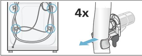
2. Dévisser les 4 cales de transport au complet et les retirer. Enlever les douilles. Sortir le cordon électrique de ses fixations.
