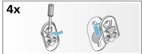
2. Mettre les 4 douilles en place. Brider fermement le cordon d'alimentation électrique contre les fixations. Mettre les vis en place et les serrer à fond.
