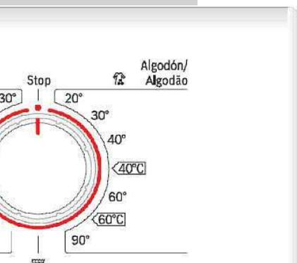
Mando selector de programas para conectar o desconectar la máquina, para seleccionar un programa de lavado. El mando se puede girar en ambas direcciones.
