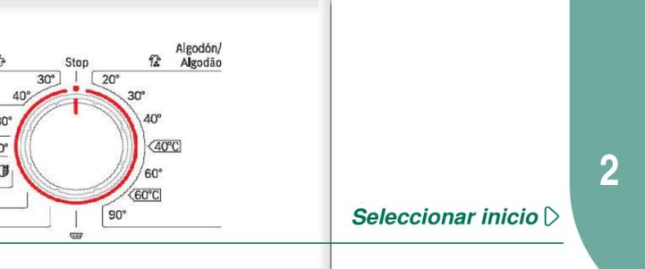
**Mando selector de programas** para conectar y desconectar la máquina, y para seleccionar un programa de lavado. El mando se puede girar en ambas direcciones.
