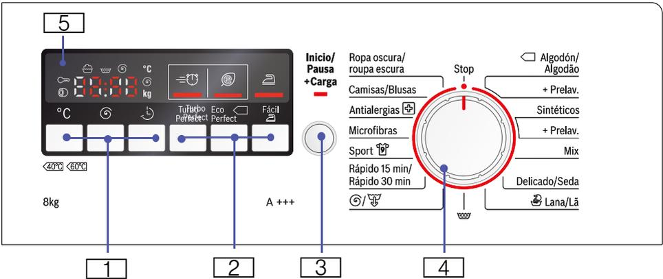
**1** °C Temperatura, Velocidad de centrifugado, Terminado en para modificar los ajustes predeterminados del programa
