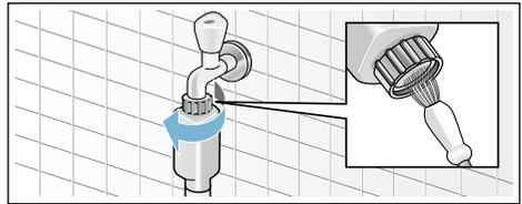
6. En los modelos Estándar y Aqua-Secure, limpiar el filtro de la parte posterior del aparato: Retirar la manguera de la parte posterior del aparato. Extraer el filtro con ayuda de unos alicates y limpiarlo.
