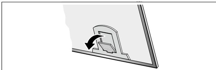
3. Metallfettfilter an der Unterseite des Gerätes herausnehmen.
