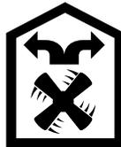
Die angesaugte Luft wird durch die Fettfilter und einen Aktivkohlefilter gereinigt und wieder in die Küche zurückgeführt.
