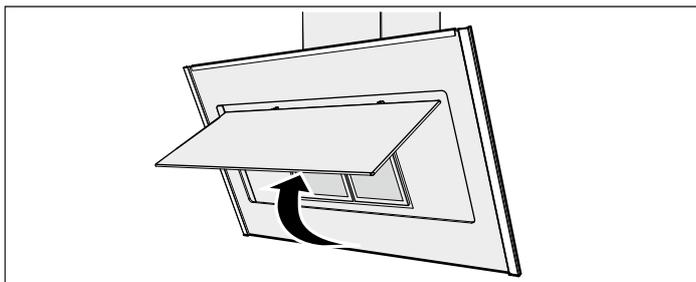
2. Die 2 Metallfettfilter unter der Filterabdeckung herausnehmen.
