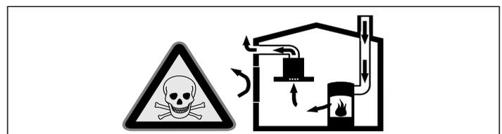
Raumluftabhängige Feuerstätten (z.B. gas-, öl-, holz- oder kohlebetriebene Heizgeräte, Durchlauferhitzer, Warmwasserbereiter) beziehen Verbrennungsluft aus dem Aufstellungsraum und führen die Abgase durch eine Abgasanlage (z.B. Kamin) ins Freie.
