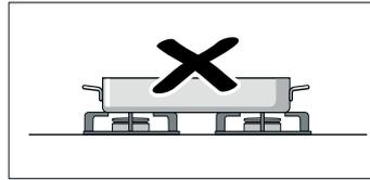
Kesinlikle bir tavayı ısıtmak için iki brülörü veya ısı kaynağını aynı anda kullanmayınız.
