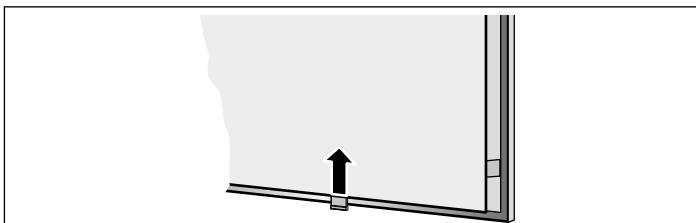
**4.** Metallfettfilter aus der Halterung herausnehmen.
