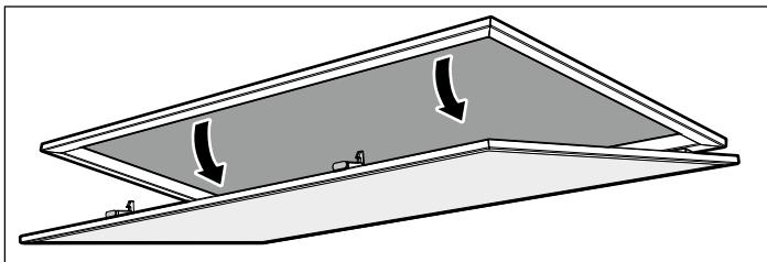
**3.** Auf Verriegelung der Metallfettfilter drücken.
