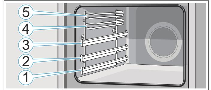
In den Einschubhöhen 4 und 5 das Zubehör immer zwischen die beiden Führungsstäbe einer Einschubhöhe schieben.
