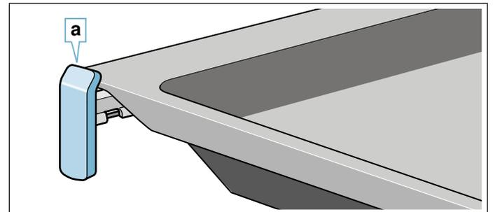
Die Auszugsschienen rasten ein, wenn sie ganz herausgezogen sind. So lässt sich das Zubehör leicht auflegen. Zum Entriegeln die Auszugsschienen mit etwas Druck zurück in den Garraum schieben.
