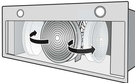
3. Pousser le filtre à charbon actif avec précaution dans les supports de fixation.
