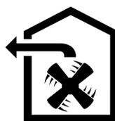
L'air aspiré est débarrassé des particules de graisse par les filtres à cet effet, transite par un conduit puis gagne l'extérieur.
