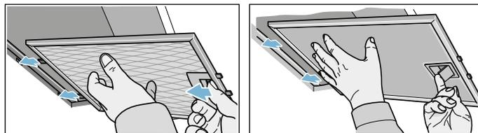
En cas de filtres à aspiration périphérique, tirer le filtre métallique à graisse vers le bas. Avec l'autre main sous le filtre métallique à graisse, interceptez ce dernier.
