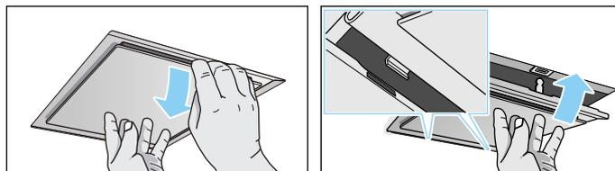
En cas de filtres supplémentaires à l'intérieur, ouvrir les verrouillages et abaisser le filtre métallique à graisse. Avec l'autre main sous le filtre métallique à graisse, interceptez ce dernier.
