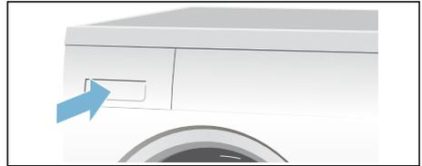
**Hinweis:** Das Sieb im Kondenswasser-Behälter filtert das Kondenswasser, das zur automatischen Reinigung Ihres Trockners verwendet wird. Das Sieb wird durch Entleeren des Kondenswassers gereinigt. Prüfen Sie das Sieb trotzdem regelmäßig auf verbliebene Ablagerungen und entfernen diese. Siehe → Seite 23.
