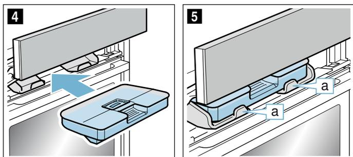
7. Poussez lentement le bandeau vers le bas, puis vers l'arrière jusqu'à ce qu'il soit entièrement fermé. Le réservoir d'eau est rempli. Vous pouvez démarrer des modes avec de la vapeur.
