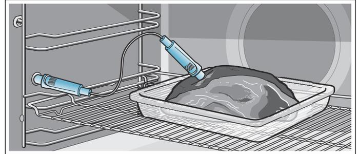
**Aves:** introducir el termómetro por la parte más gruesa de la pechuga hasta el tope. Según la forma del ave, introducir el termómetro de asado en sentido transversal o longitudinal. Después, girar el ave y colocarla en la parrilla con la pechuga hacia abajo.
