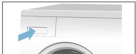
**Avvertenza:** Il filtro nel contenitore dell'acqua di condensa filtra l'acqua di condensa che viene utilizzata per la pulizia automatica dell'asciugatrice. Svuotando l'acqua di condensa il filtro viene pulito. Ciononostante controllare regolarmente che non ci siano depositi di impurità nel filtro. In caso contrario, rimuoverli. Vedere → *Pagina 24*.
