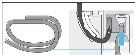
5. Fissare il tubo di scarico dall'altro lato agli altri accessori a seconda della tipologia di allacciamento A, B o C.
