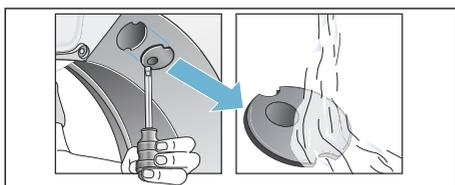
1. Aprire lo sportello e rimuovere la copertura dell'ugello vapore con un cacciavite.
