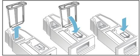
8. Inserire il contenitore dell'acqua di condensa fino all'arresto.
