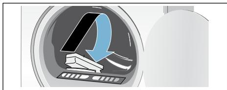
Aprire lo sportello e pulire il sensore di umidità con una spugna umida e ruvida.
