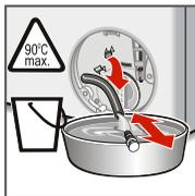
4. Staccare il raccordo flessibile dal suo alloggiamento per lo svuotamento di emergenza. Estrarre il tappo di chiusura. Fare scorrere l'acqua in un idoneo contenitore. Applicare il tappo di chiusura e ricollocare il raccordo flessibile nel suo alloggiamento.
