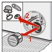
5. Svitare con precauzione il coperchio della pompa. Pulire interno, la filettatura del filtro pompa e corpo pompa (la girante della pompa deve ruotare liberamente).
