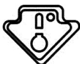
In de koelruimte is de „zone voor gevoelige levensmiddelen” door de pijl gekenmerkt. Deze zone bevindt zich, afhankelijk van het model, helemaal onderaan tussen de aan de zijkant afgebeelde pijl en de glasplaat eronder (afb. **1/1** en **1/2**) of tussen de twee pijlen (afb. **2/1** en **2/2**) of als er geen pijlen zijn afgebeeld, in de hele koelruimte behalve in de omgeving van de deur.
